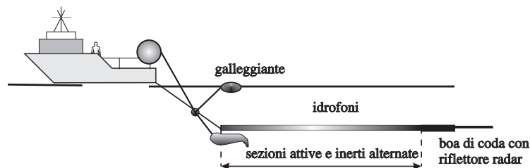
Figura 2.7: Sistema di acquisizione marina (linea di idrofoni).
